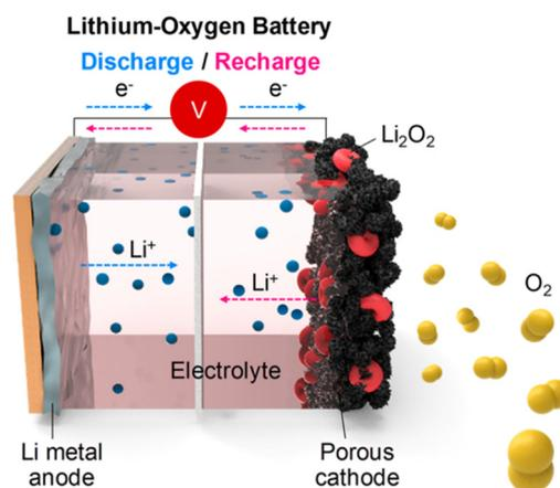
图1 锂氧电池示意图<sup>5</sup>
